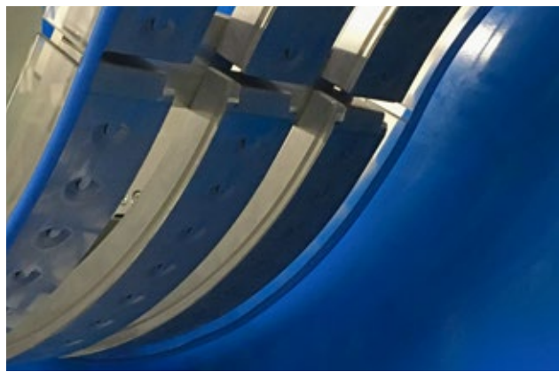
Auch Materialdrehungen vor dem Schneiden um 180° sind mithilfe angepasster Luftleisten möglich.
